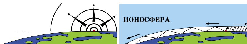
Рис. 5. Слева – распространение со временем единичного сигнала видимого света, а справа – радиосигнала, отражаемого ионосферой
